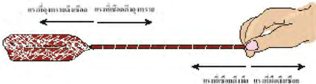
รูป 3.19 แรงคู่กิริยา - ปฏิกิริยาเมื่อมือดึงตุ้มน้ำ
