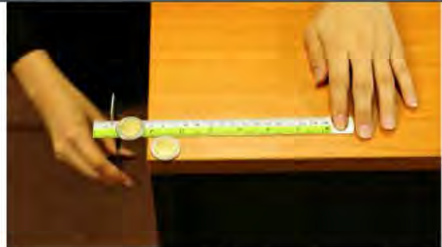
รูป 4.3 การเคาะไม้บรรทัดให้เหรียญทั้งสองเคลื่อนที่
