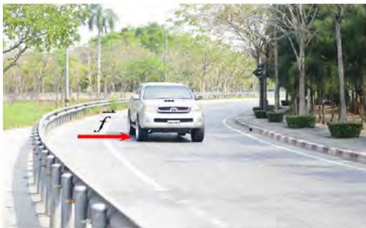
รูป 4.20 แรงเสียดทานระหว่างยางกับถนนทางด้านข้างทำหน้าที่เป็นแรงสู่ศูนย์กลางของรถยนต์ที่กำลังเลี้ยวโค้ง
