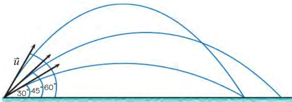
รูป 4.11 พิสัยของวัตถุที่ถูกขว้างออกไปด้วยอัตราเร็วค่าหนึ่ง แต่มุมต่างกัน
