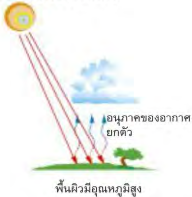
ภาพ 3.8 การยกตัวของอนุภาคอากาศเนื่องจากความร้อน
